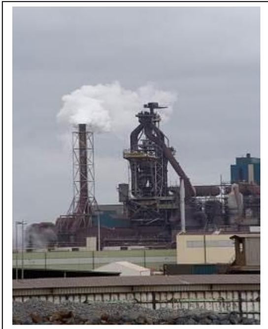
L'installation utilisée pour transformer le minerai de fer est le haut-fourneau dans lequel règne une température de presque 2100°C. On y verse le minerai de fer, le coke et la pierre calcaire et on y souffle de l'air chauffé à une température d'environ 1100°C
