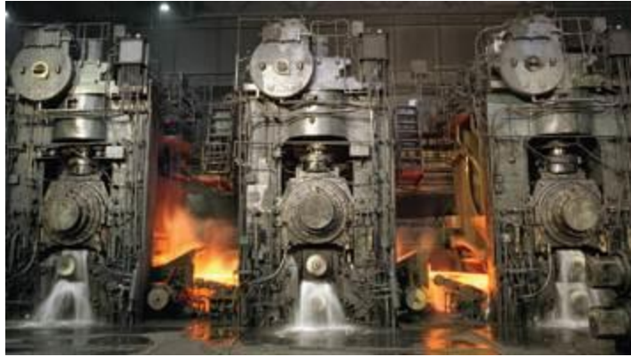
Laminage à chaud
